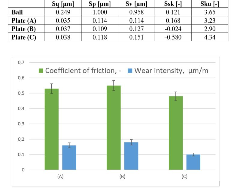
**MACHINED SURFACE PARAMETERS**
